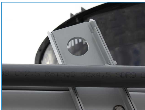
Ke zvednutí jednotky použijte závěsná a zvedací oka.
