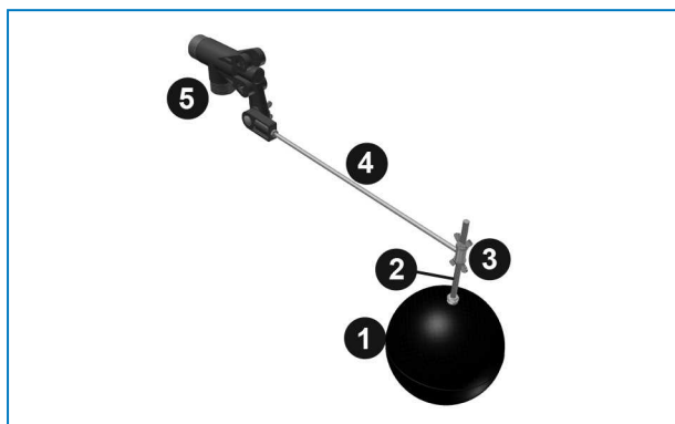
Sestava doplňovacího ventilu přídatné vody
