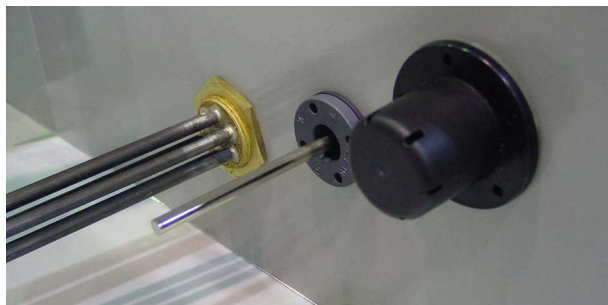
Ohřivač sběrné nádrže
